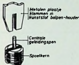
Fig. 14 Schets van de trimsleutel en vorm van de bovenzijde van de spoelkern.
